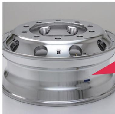
スペインから輸入した全自動研磨システム。ポーランドの光沢は、業界で最も明るい1600GUに達します。
